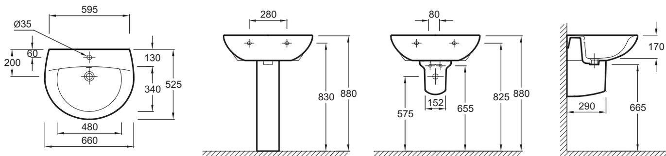
Спецификация продукта: Раковина. E1998G. Коллекция: PATIO. РАЗМЕРЫ (СМ): 66 x 52,50 см. ВЕС: 17,5 кг. МАТЕРИАЛ: Санфарфор. ТИП УСТАНОВКИ: Подвесные. РАЗМЕТКА СВЕРЛЕНИЯ ОТВЕРСТИЯ ДЛЯ СМЕСИТЕЛЯ: С 1 отверстием для смесителя, 2 размечено. ОТВЕРСТИЯ ДЛЯ СВЕРЛЕНИЯ: С 1 отверстием для смесителя, 2 размечено. ОТВЕРСТИЕ ПЕРЕЛИВА: С отверстием перелива.
